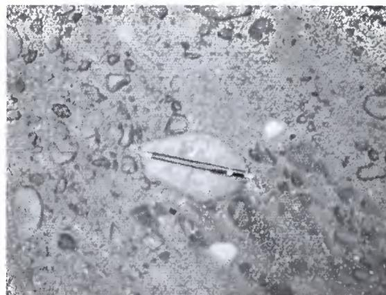
Fotografía N° 8: Se puede establecer que el tamaño del material granular es de aproximadamente de 140 mms, correspondiente al kilómetro 8,020.
